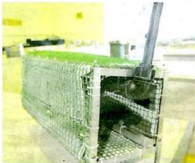
PENAPIS berfungsi untuk menapis air dan sisa tercemar akan terperangkap di dalamnya.
