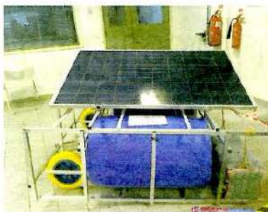
ALAT ini dikuasakan oleh panel solar 250 watt dan beroperasi 24 jam.
